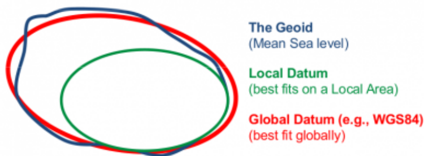
Figura 10: Comparación entre datum local y datum geocéntrico
